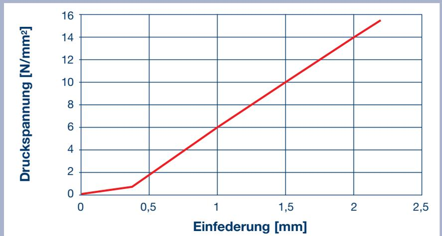
Bild 5: Einfederung  $\Delta t$  (näherungsweise)
