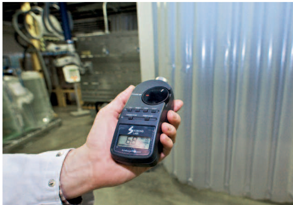
^ Bei einer mit Cisilent ummantelten Glaswaschmaschine der Firma Scheuten-Solar geht der Lärmpegel um 15 dB(A) zurück.
